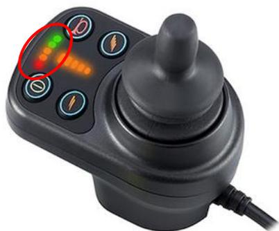
Lorsque le système électrique est allumé, l'indicateur de batterie (2, §3.3) affiche le niveau de charge de la batterie.
