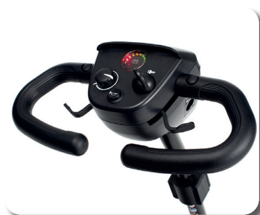
Benutzerfreundlicher Controller mit LED-Batteriestatusanzeige
